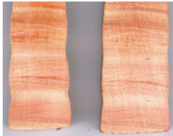
Detalle de recuperación del colapso producida tras el acondicionado final
