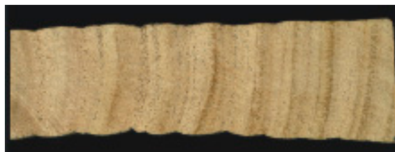
Manifestación del colapso en un despiece radial
