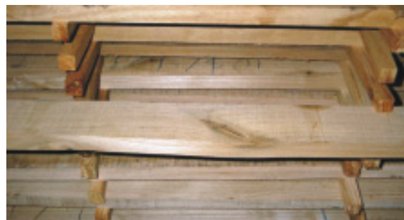
Deformaciones durante el proceso de secado, debidas a la desviación de fibra originada por la presencia de nudos
